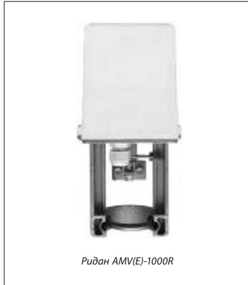
Электропривод предназначен для управления регулирующими клапанами VRB-2R/3R DN 15–50. Управление приводом Ридан AMV-1000R осуществляется по импульсному сигналу от трехпозиционных электронных регуляторов Ридан ECL-3R/4R или подобных. Приводы Ридан AME-1000R управляются аналоговым сигналом.
